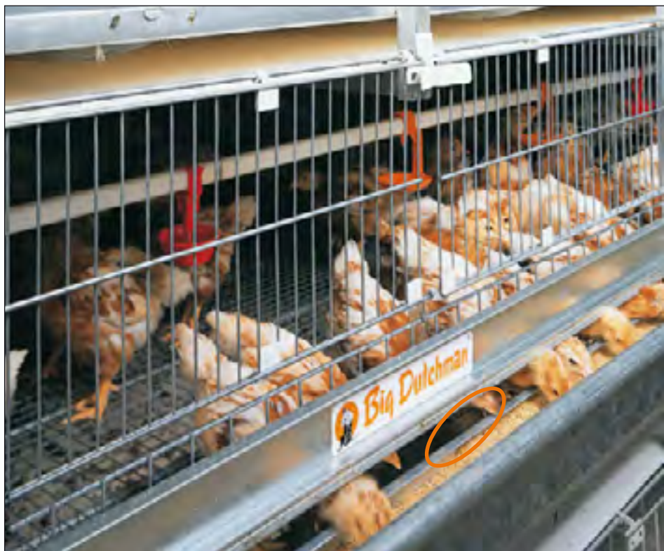
育雏层 - 带连续开放采食窗口和防止饲料浪费的料槽内缘
