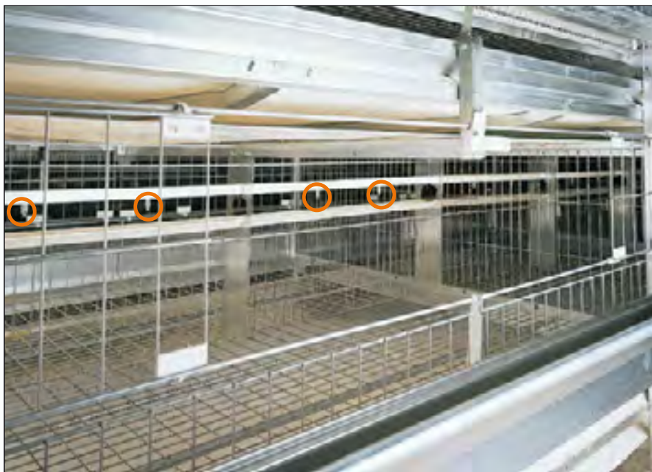
UV-S-630 生长层 - 4个不锈钢饮水乳头为家禽提供新鲜的饮水
